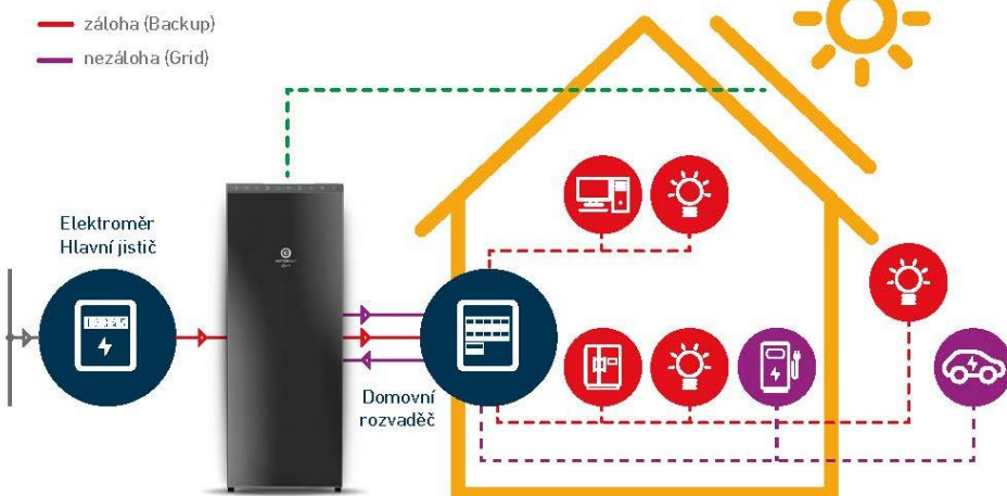
Obr. 6 – Schéma zapojení okruhů Záloha a Nezáloha při dostupné distribuční síti
