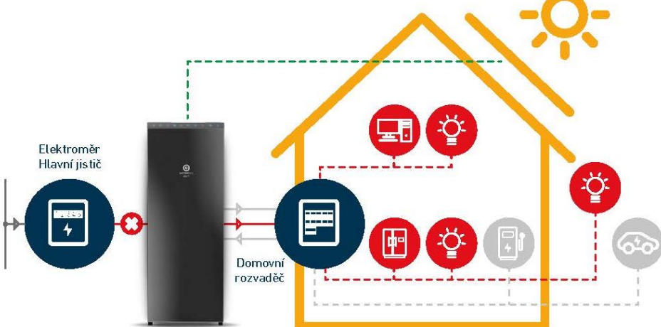
Obr. 7 – Schéma zapojení okruhů Záloha a Nezáloha při nedostupné distribuční síti
